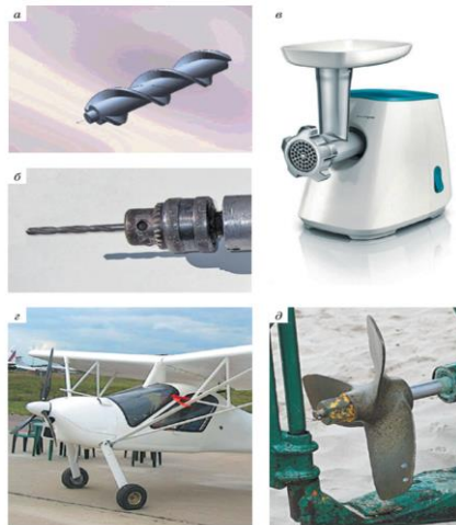
Рис. 14.2. Применение винта: а — шнек; б — сверло; в — мясорубка; г — пропеллер; д — гребной винт
